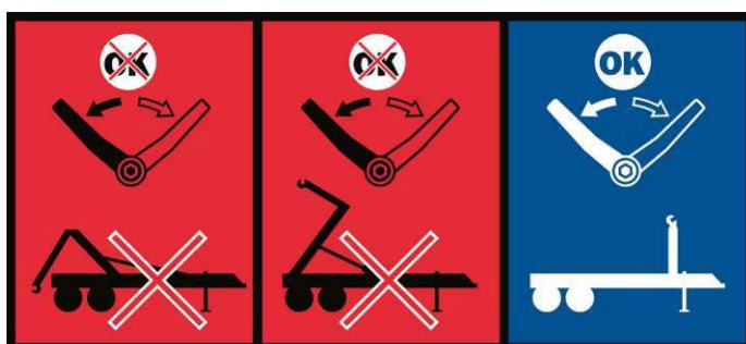
Figuur 23. Wisseleenheid gebruiken
