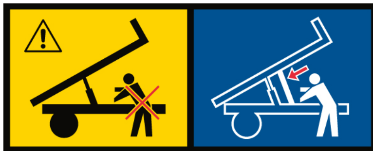
Figuur 24. Gebruik de veiligheidssteun bij alle service
