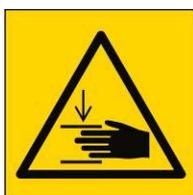
Figure 19. Risque de blessure par serrage
